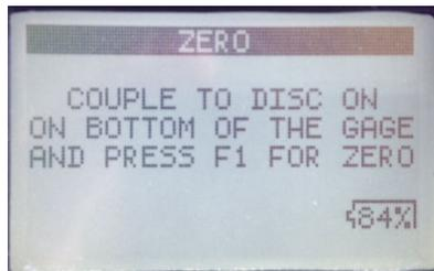
**COUPLE TO DISC ON BOTTOM OF THE GAGE AND PRESS F1 FOR ZERO**
